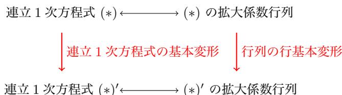
どのような連立 1 次方程式 (\*) も上記の連立 1 次方程式の基本変形だけを繰り返し用いることにより、解に最も近い形の連立 1 次方程式 (\*)' に変形出来る。この方法で連立 1 次方程式を解くことを**掃き出し法**という。ここで、解に最も近い形の連立 1 次方程式 (\*)' とは、その拡大係数行列  $K'$  が以下の 4 条件 (i), (ii), (iii), (iv) 全てをみたすことをいう：
